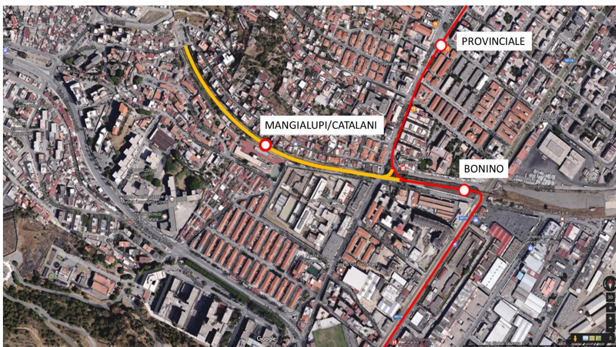
Fig. 22 - Possibile nuovo tracciato tranviario a seguito della rimozione dell'ex sede ferroviaria
